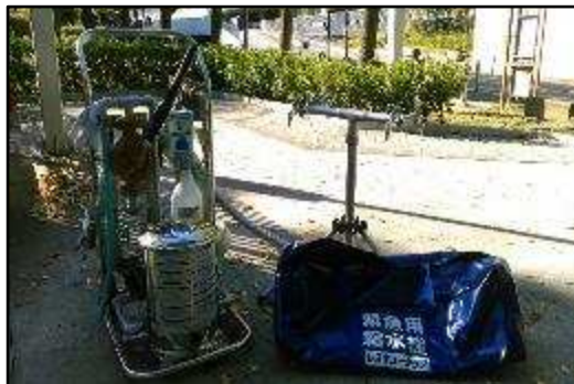
〔非常用浄水装置〕
