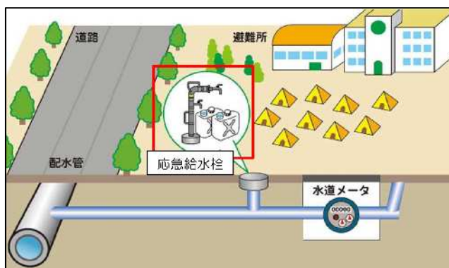
[応急給水栓の整備イメージ]
