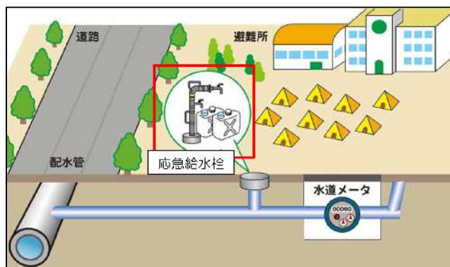
[応急給水栓の整備イメージ]
