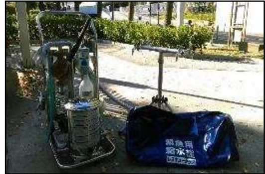
[非常用浄水装置]
