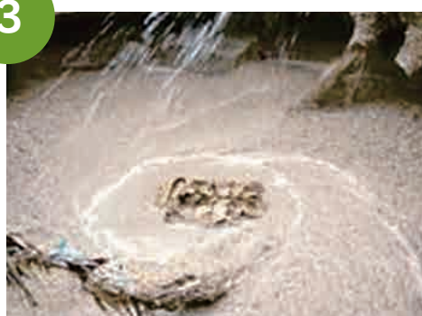
製紙工場に運ばれ、ミキサーで古紙を溶かす
