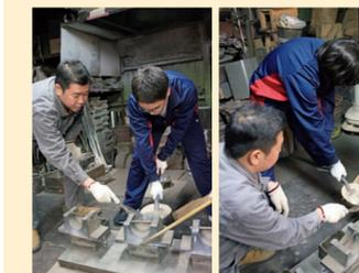
いよいよ砂型へ流し込む「鑄込み」の作業。溶けた錫は水のようにサラサラですが、すぐに固まってしまうので素早く流し込みます。両足を左右に広げ姿勢を整えたら、バランスを崩さないようにしっかりと容器を持ち、一気に流し込む！
