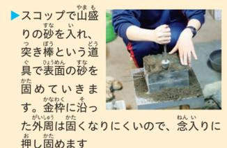
スコップで山盛りの砂を入れ、突き棒という道具で表面の砂を固めていきます。金枠に沿った外周は固くならにくいので、念入りに押し固めます
