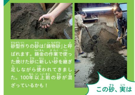
砂型作りの砂は「鑄物砂」と呼ばれます。鑄金の作業で使った焼けた砂に新しい砂を混ぜ足しながら使われてきました。100年以上前の砂が混ざっているかも！
