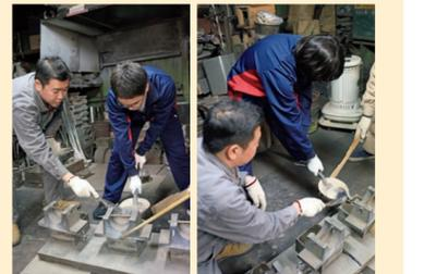
いよいよ鑄型へ流し込む「鑄込み」の作業。溶けた錫は水のようにサラサラですが、すぐに固まってしまうので素早く流し込みます。両足を左右に広げ姿勢を整えたら、バランスを崩さないようにしっかりと容器を持ち、一気に流し込む！
