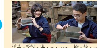
上下の金枠を押さえながら、胸の前まで上げた砂型を回転させます。ここで御神本さんの砂型が崩れてしまい、再チャレンジ！ 裏面も同じ作業を繰り返したあと、慎重に原型を外します
