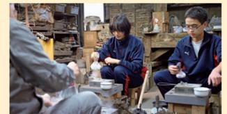
▲「型どめ」とは、金属を流し込むための砂型を作る作業。押し台の上に原型を乗せて、砂が張り付かないように「別れ砂」と呼ばれる白い粉を振りかけます。別れ砂には、牡蠣の殻から作る白い色の絵の具・胡粉が含まれています
