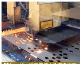
2 レーザー加工機による抜き加工
