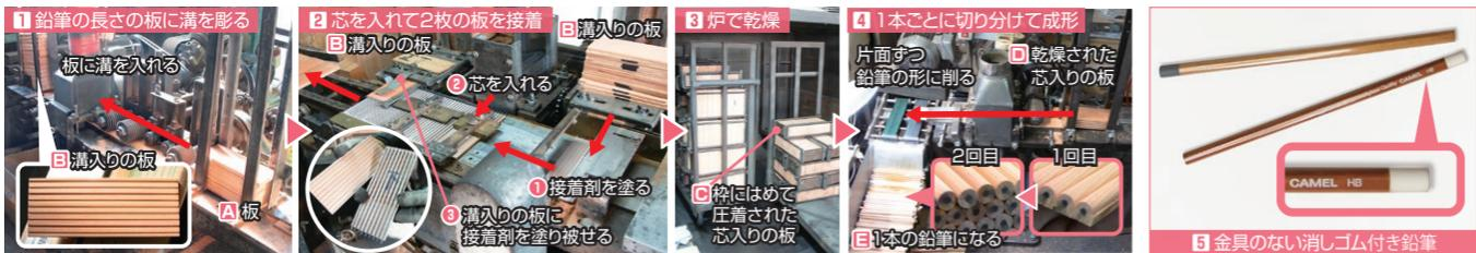
【鉛筆の製造工程1~4】1 板に芯を入れるための溝を一定間隔で彫ります。2 板に接着剤を塗り、溝に芯を入れて2枚を貼り合わせて圧着します。3 炉で接着剤と板を乾燥させます。4 上の面を鉛筆の形に削り、裏返して下の面を同じように削り、1本ずつの鉛筆の形にします。(このあと塗装などの加工を行い完成) 5 加藤さんが考案した金具のない消しゴム付き鉛筆は、国内外で人気のキャメルブランドの定番製品です。
