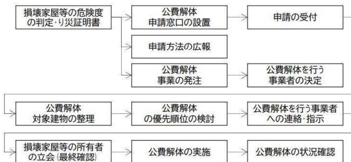
図 14 損壊家屋の撤去・解体の手順
